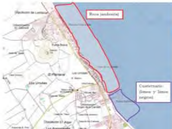
Figura 4.- Zonas diferenciadas en el estudio geotécnico.
