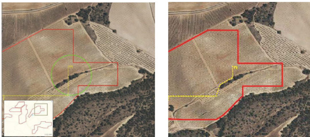
Figura 4. Modificación de la línea de media tensión para evitar afección a vegetación natural.
