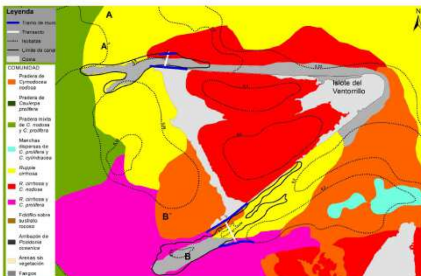
Mapa 2. Línea de costa y batimetría del islote de la gola del Ventorrillo obtenidos en 2014 por el GEAM-IEO. Las líneas blancas indican las secciones (A-A' y B-B') sobre las que se tomaron medidas georeferenciadas de profundidad para caracterizar el perfil batimétrico de los antiguos canales (línea continua negra). La línea azul indica la presencia de tramos de muros de piedra que delimitaban antiguamente los canales. Los diferentes colores indican las diferentes comunidades de macrófitos bentónicos de acuerdo con la leyenda y datos obtenidos en 2014. Fuente: GEAM-IEO.
