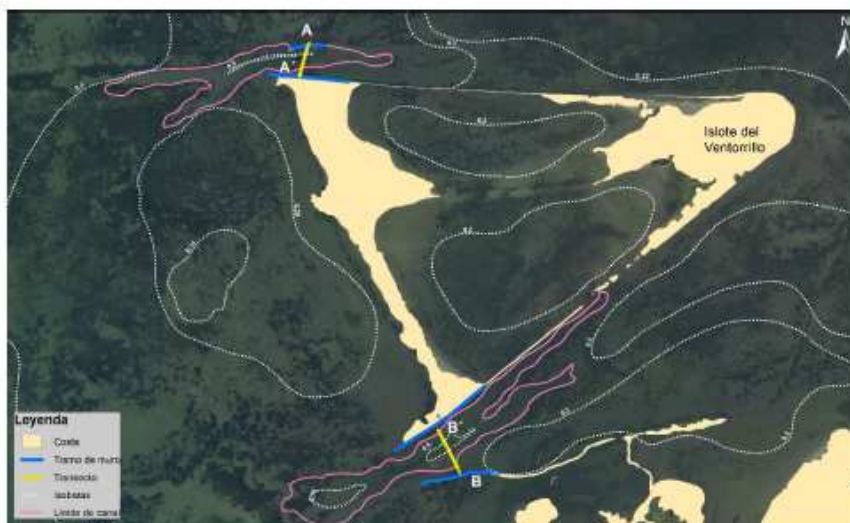
Mapa 1. Línea de costa y batimetría del islote de la gola del Ventorrillo obtenidos en 2014 por el GEAM-IEO. En amarillo se indican las secciones (A-A' y B-B') sobre las que se tomaron medidas georeferenciadas de profundidad para caracterizar el perfil batimétrico de los antiguos canales (línea rosa). La línea azul indica la presencia de tramos de muros de piedras que delimitaban antiguamente los canales. Fuente: GEAM-IEO.
