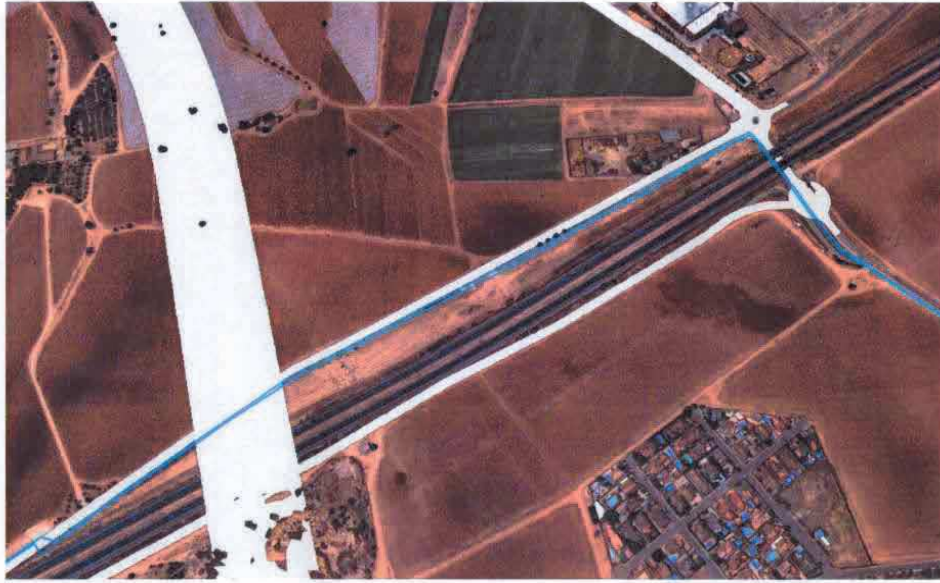
Imagen nº2: Las dos conducciones paralelas afectadas por el vial de la terminal intermodal y el acceso viario nº4.
