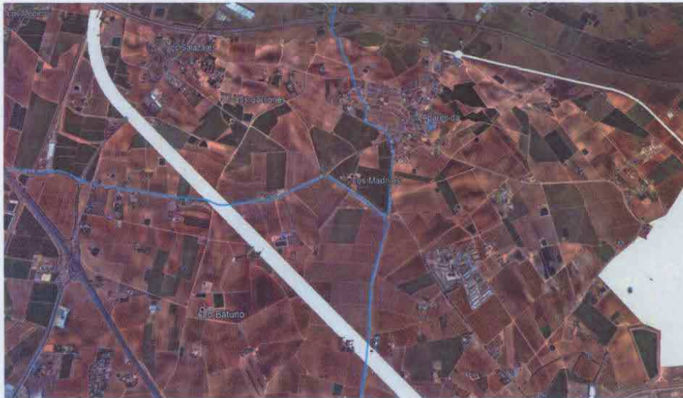
Imagen nº1: Los dos ramales de conducciones afectados por el vial de la terminal intermodal.
