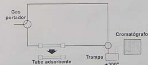
Figura 2.- Esquema de funcionamiento del sistema de desorción térmica.
