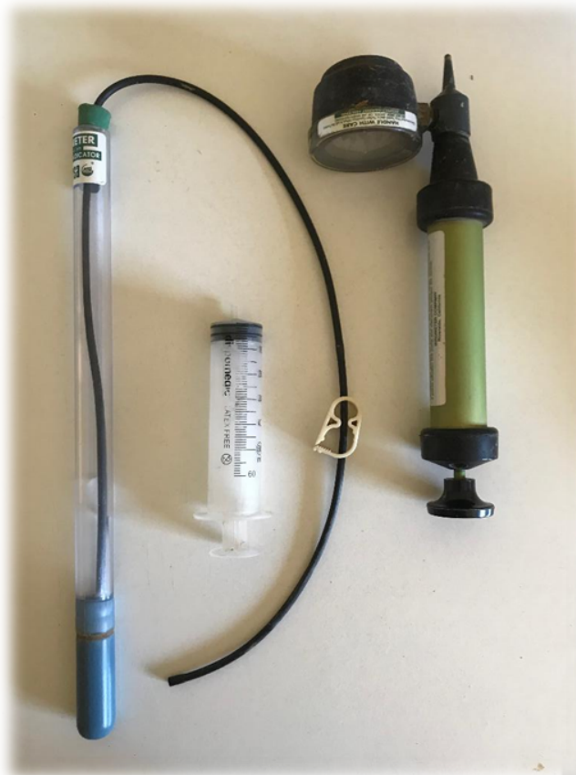
Imagen nº2 Sonda de succión y válvula para hacer el vacío
