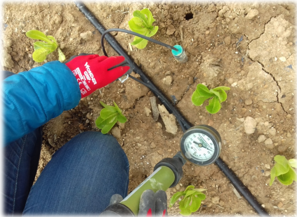
Imagen nº3 Obtención vacío en la sonda de succión
