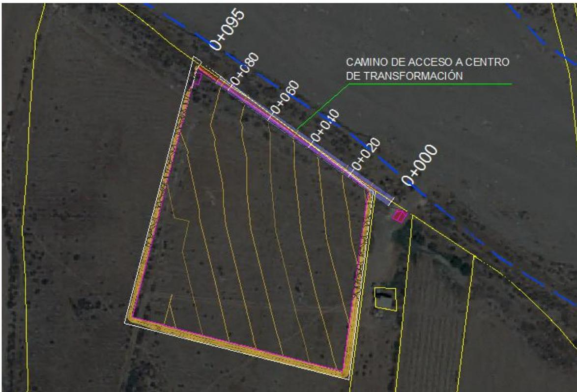
Fig. 4. Diseño Camino de Acceso a Centro de Transformación.
