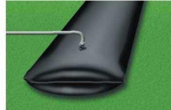
**Etapa 2: Deshidratación.** El agua filtrada sale del Geotubo a través de pequeños poros del geotextil. Esto permite una deshidratación efectiva y una notable reducción del volumen de los materiales. Esta reducción de volumen permite volver a llenar el Geotubo varias veces hasta llenarlo totalmente. Se puede llegar a retener hasta el 99% de los sólidos, de forma que el agua pueda retornarse a la laguna una vez clarificada.
