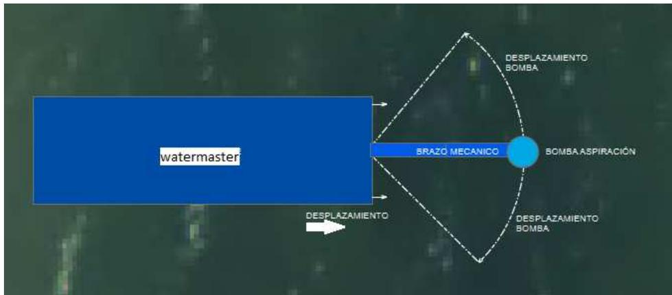
Imagen nº 4 – Croquis de desplazamiento de la bomba de aspiración y del equipo Watermaster.
