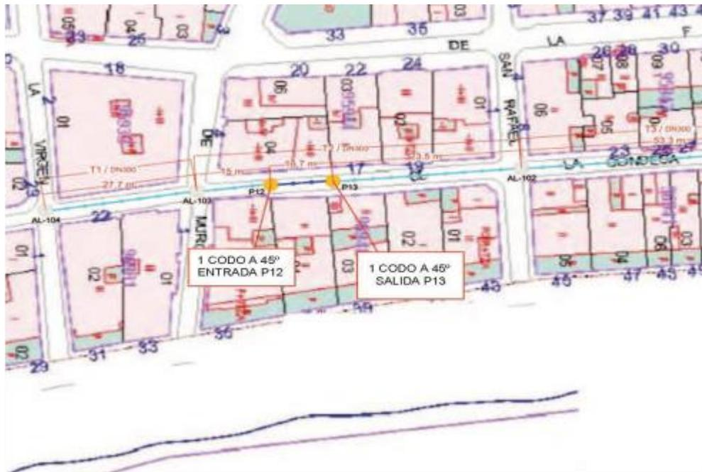
1.- Existen dos codos a 45° en el tramo nuevo de la tubería para conectar los dos pozos nuevos P12 y P13 con la red existente, lo que imposibilita la instalación de la manga y el paso del tren de luces para el fraguado, ya que solo se pueden reparar tramos rectos de tubería entre pozos.
