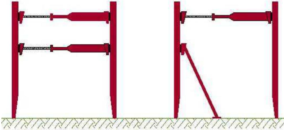
Antes de continuar deberá comprobarse que la distancia entre paneles es la deseada. De todos modos deberá tenerse en cuenta que la distancia entre los paneles inferiores, será unos 5 cm mayor que la de los paneles en altura
