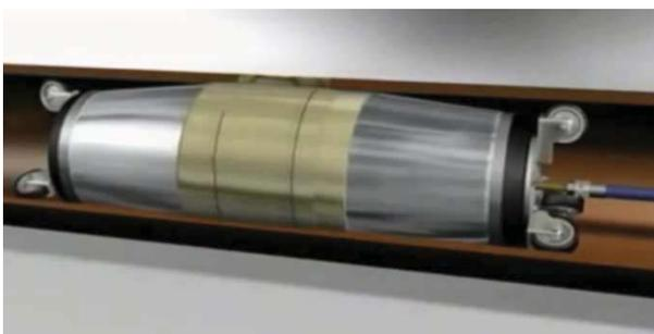
7. **Curado y retirada del packer:** Cuando ha transcurrido el tiempo de curado que se indica en las tablas de las resinas, el manguito tiene la rigidez suficiente como para poder desinflar y retirar el packer.
