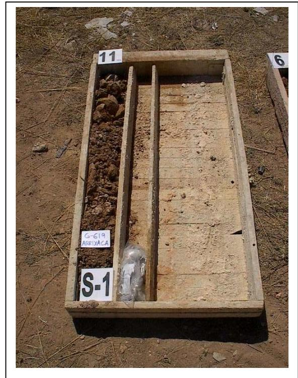
**Fotografías nº 4, 5 y 6: Cajas de Testigos. Sondeo 1. Profundidad de 0,00 a 11,40 m.**
