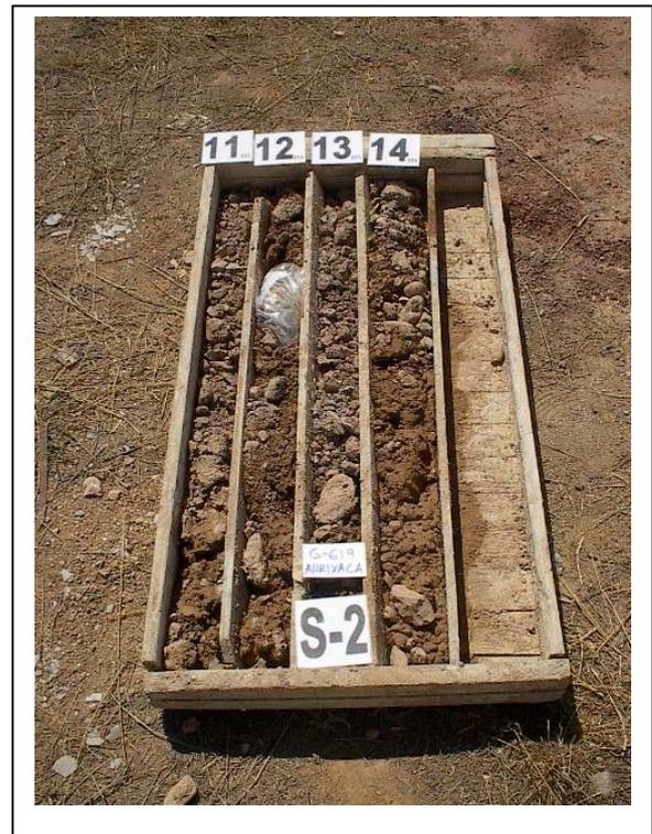
**Fotografías nº 7, 8 y 9: Cajas de Testigos. Sondeo 2. Profundidad de 0,00 a 14,00m.**
