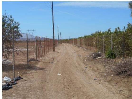
TRAMO EN TIERRA. LIMITADO POR VALLAS DE FINCAS. EXISTENCIA DE 3 POSTES DE MADERA DE BAJA TENSIÓN. ANCHO 6.00 ml Y PASO LIBRE A LA ALTURA DEL POSTE 5.20 ml
