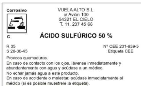
Señales panel para recipientes y tuberías (etiquetado).
