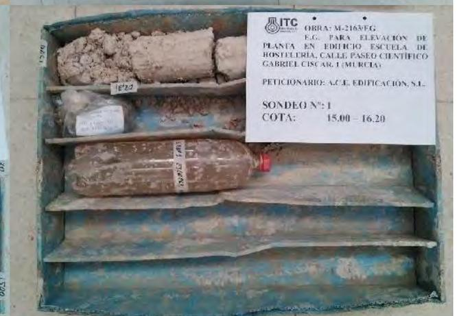
ENSAYO NORMAL DE PENETRACIÓN (S.P.T.) UNE 103800/92, TOMA DE MUESTRA INALTERADA (INAL) XP P94-202 , TOMA DE MUESTRA PARAFINADA (TP) 7371/75, TOMA DE MUESTRA DE AGUA FREÁTICA (MA) ANEJO 5 DE LA EHE
