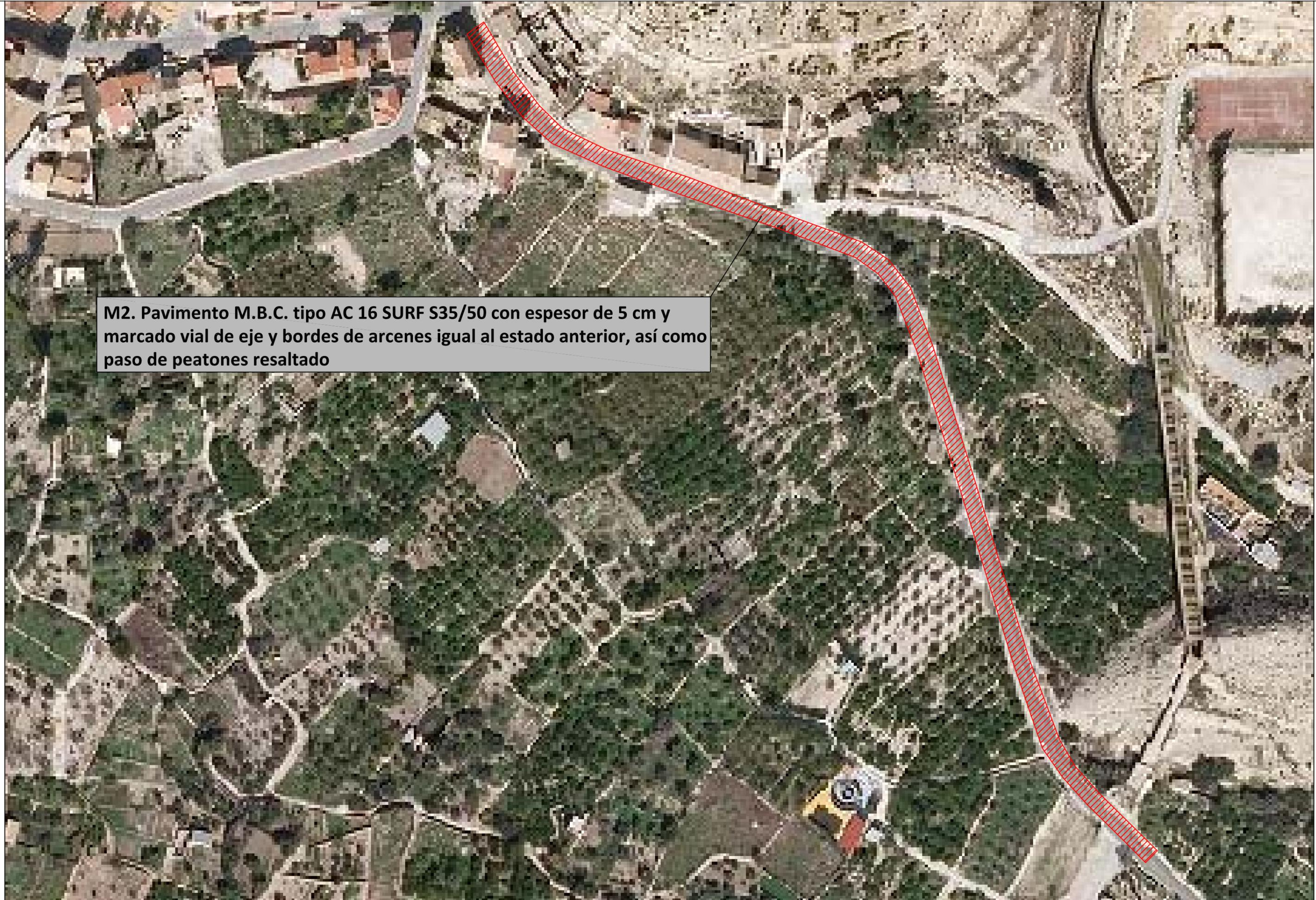
**M2. Pavimento M.B.C. tipo AC 16 SURF S35/50 con espesor de 5 cm y marcado vial de eje y bordes de arcenes igual al estado anterior, así como paso de peatones resaltado**
