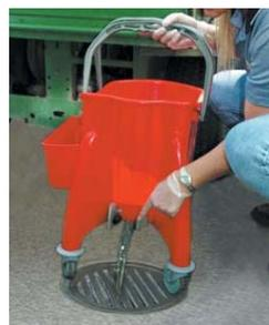
Es aconsejable limitar el contenido de los cubos a unos 5 litros de agua, y en su llenado y vaciado contar con elementos que eviten la manipulación de peso, como mangueras adaptadas, cubos con abertura de drenaje y sumideros a ras del suelo para vaciar los cubos evitando así su levantamiento. En todo caso, si resulta inevitable el levantamiento, siempre se debe cumplir con las normas básicas de manejo manual de cargas.
