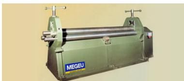
En esta ficha nos centraremos en la curvadora de tres cilindros. Los dos rodillos que se sitúan en el plano inferior, por el accionamiento de un motor, arrastran la chapa que pasa entre estos y el tercer rodillo, colocado sobre los anteriores. Éste último es regulable en altura al objeto de poder modificar la curvatura de dicha chapa.
