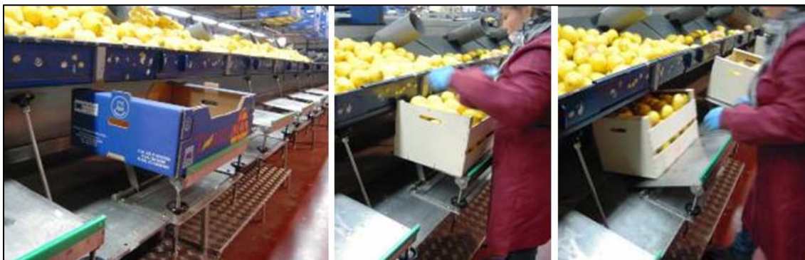
Plataforma regulable en altura con palanca de accionamiento para deslizar las cajas
