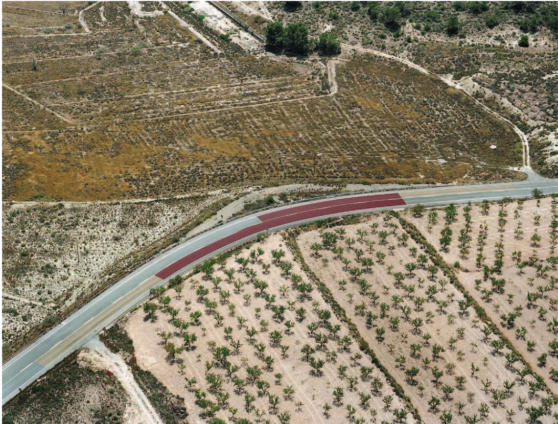
PAVIMENTOS ANTIDESLIZANTES EN TRAMOS CURVOS
