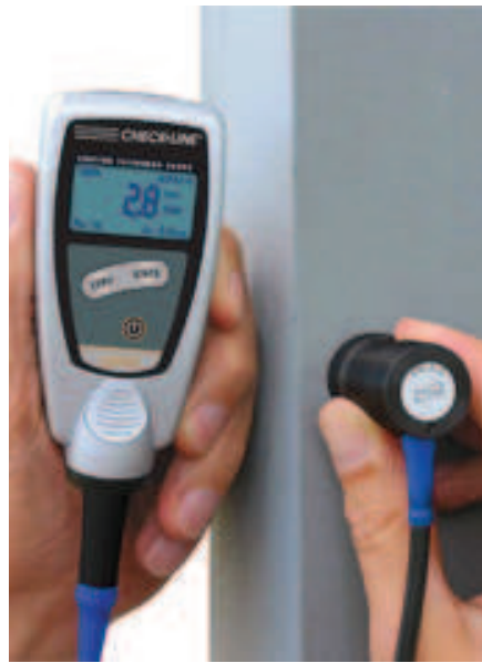
Figura 9.4.1.1. Medidor de espesores 3000EZ-E Series. Checkline Europe
