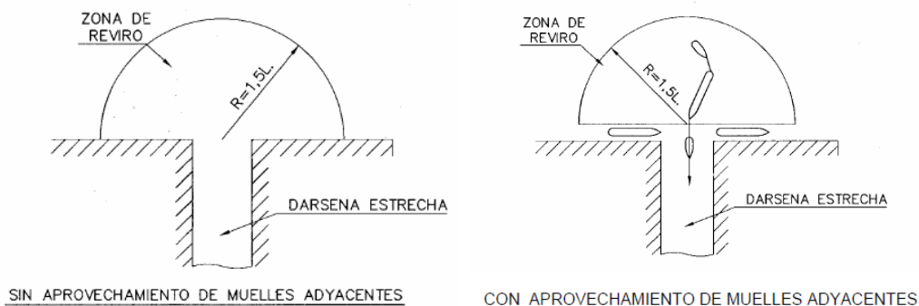
Figura 7. Dimensionamiento de áreas de reviro en la bocana de acceso al puerto
