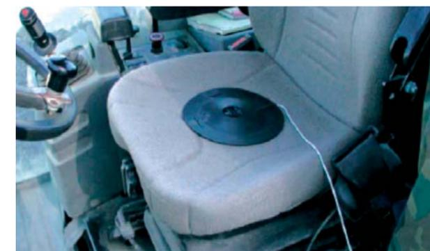
Acelerómetro colocado en el asiento del conductor
