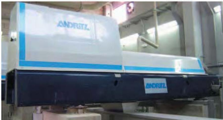
El fango procedente del espesador llega a esta etapa del proceso donde se concentra retirando agua del fango. Este proceso puede ser químico, mecánico...
