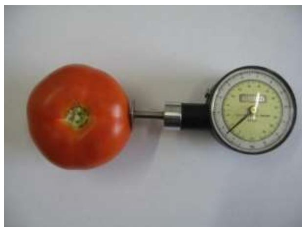
Foto 28: Medida de la dureza con el penetrómetro
