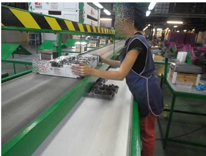
Colocación en la cinta intermedia con la altura reducida
