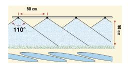
La altura de la barra depende del tipo de boquilla, por lo que debe verse en el catálogo del fabricante. Lo habitual son las boquillas que trabajan a 50 cm de altura.
