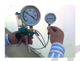
Con la ayuda de un comprobador de presión para manómetros y teflón, se realiza la comprobación del manómetro de la máquina, con la participación de los asistentes a la práctica.
