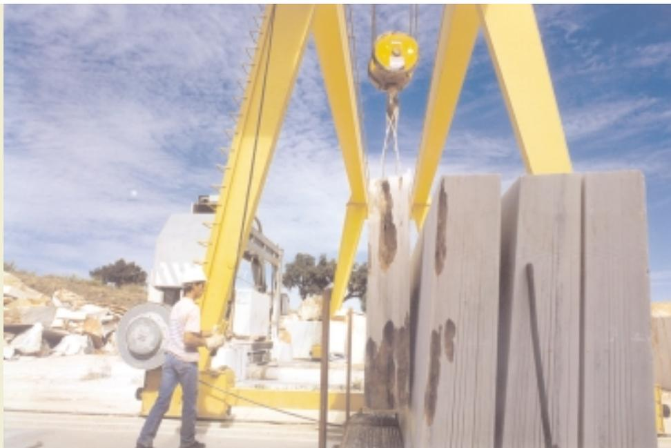
Una vez en este punto, se examina el bloque para localizar las posibles grietas y realizar el marcado de corte. Previamente al corte se realiza un proceso de precorte con aquellos bloques que presenten unas dimensiones o formas poco adecuadas. Este precorte se realiza mediante telar con una sola lámina de corte o mediante corte con hilo diamantado, con el fin de aprovechar al máximo los materiales.
