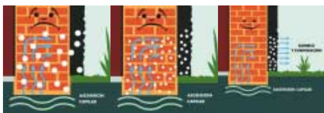
En edificios con cimentación directa sobre el terreno, los muros van absorbiendo agua y humedad del mismo, fenómeno que se denomina remonte capilar.
