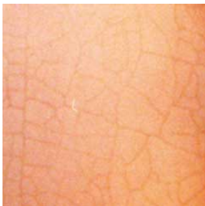
MICROFISURAS: Aparecen en el revestimiento endurecido. Normalmente son inferiores a 1 mm., y están dispuestas en forma de "tela de araña" o "red".
