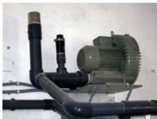
Fotografía 1.8: Sistemas de agitación mecánico (izquierda) y mediante aire (derecha).
