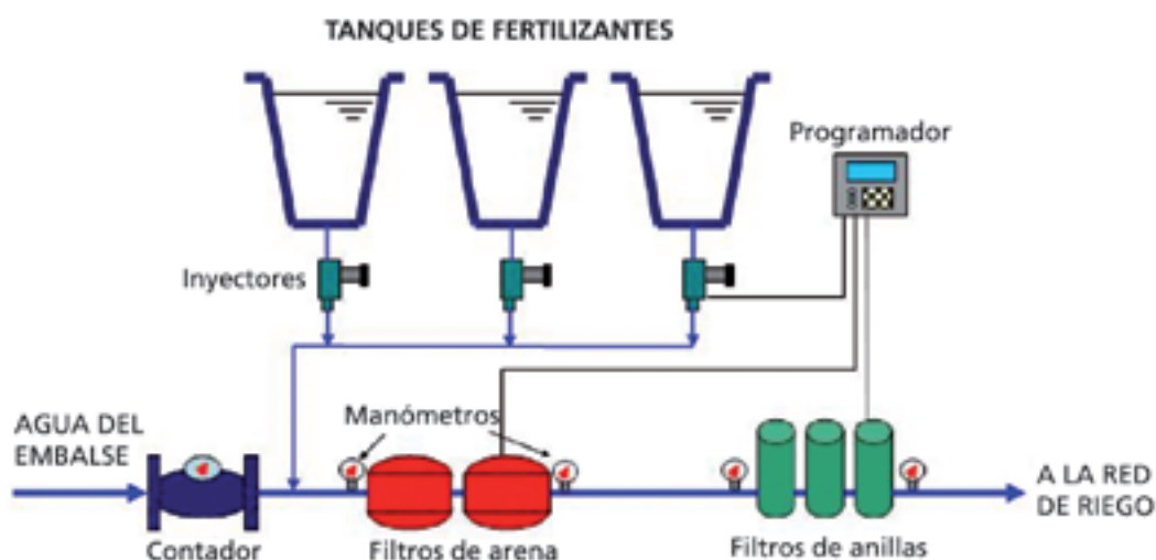
Figura 1.2: Esquema de un cabezal de riego.
