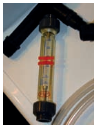
Fotografía 1.15: Instalación de rotámetros en un moderno equipo de fertirrigación.
