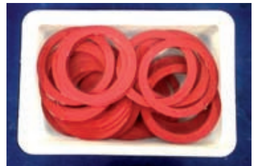
Fotografía 3.3: Colocación de anillas en ácido para una limpieza en profundidad.
