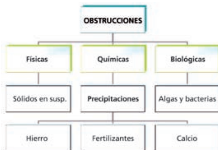
Figura 2.1: Tipos de obstrucciones.
