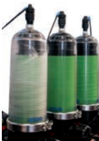
Fotografía 3.5. Batería de filtros de discos autolimpiantes, y detalle de limpieza automática por contralavado con chorros de agua a presión.
