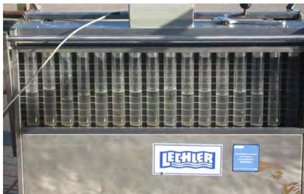
Resultado en las probetas del banco de pruebas de los volúmenes aplicados
