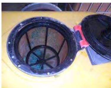
Tapa de llenado deposito.
