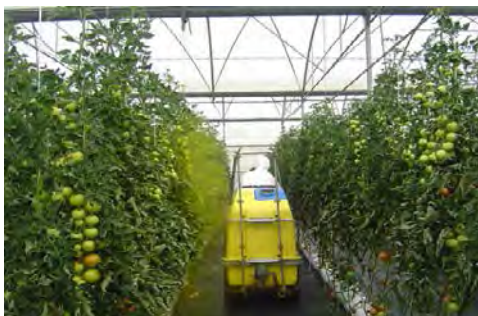
Pulverizador hidráulico, mediante barra vertical.
