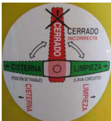
dhesevo posición válvulas para limpieza
