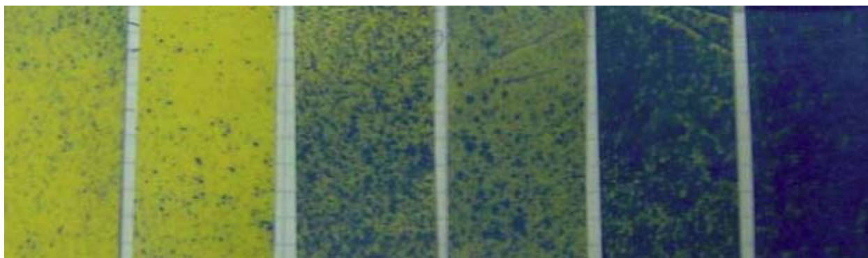
Tarjetas hidrosensibles. Diferentes impactos de gota.
