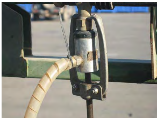
Sistema para recoger el caudal de cada boquilla
