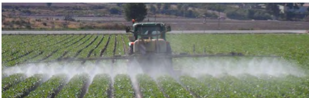
Pulverizador hidráulico suspendido para cultivos hortícolas
