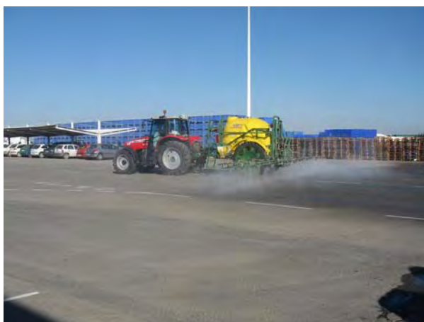
Prueba del pulverizador con agua sobre asfalto
