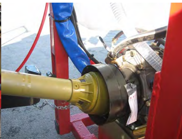
Comprobación de la protección de la transmisión cardánica del eje y la campana de la
