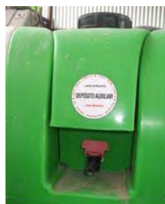
Deposito uso operador
