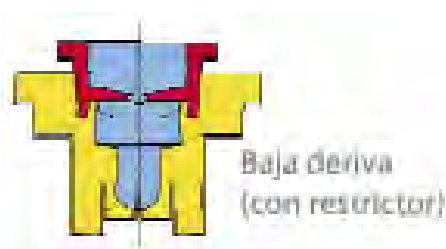
Boquillas baja deriva con sistema restrictor e inyección de aire
