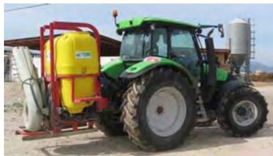
Pulverizador hidroneumático: Cañón atomizador
