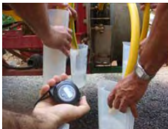
Medición caudal boquillas
