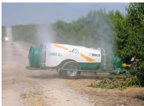
Atomizador turbo alimentado arrastrado
