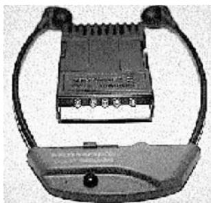
Figura 7. Equipo de Infrarrojos para transmisión del sonido
