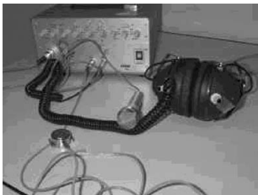
Figura 9. Suvag II con micrófono, auriculares y vibrador.
