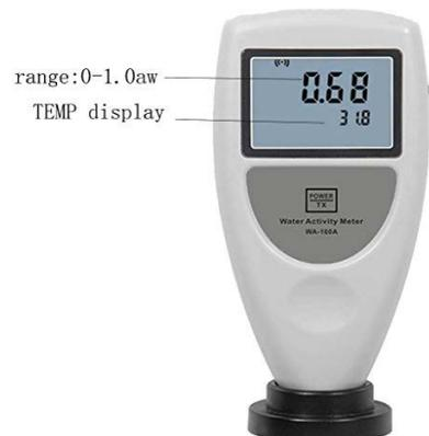
**Figura 6. Aparato para medir la actividad del agua ( $A_w$ )**
