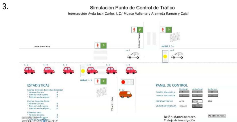
En la simulación se puede comprobar que cambiando la densidad vehicular, cambian a su vez los tiempos de ciclo semafórico y la velocidad vehicular, lo que ayuda a la fluidez del tráfico y la disminución de los tiempos de espera.
