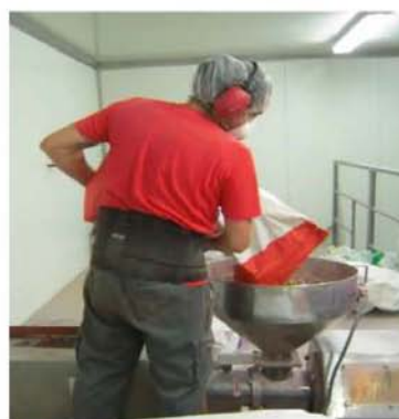
■ Vaciado de sacos de 25 kg en la tolva de trituración.
