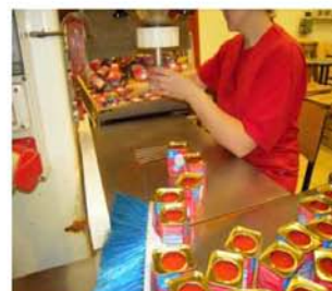
■ Llenado de botes de pimentón realizado de forma cíclica.
