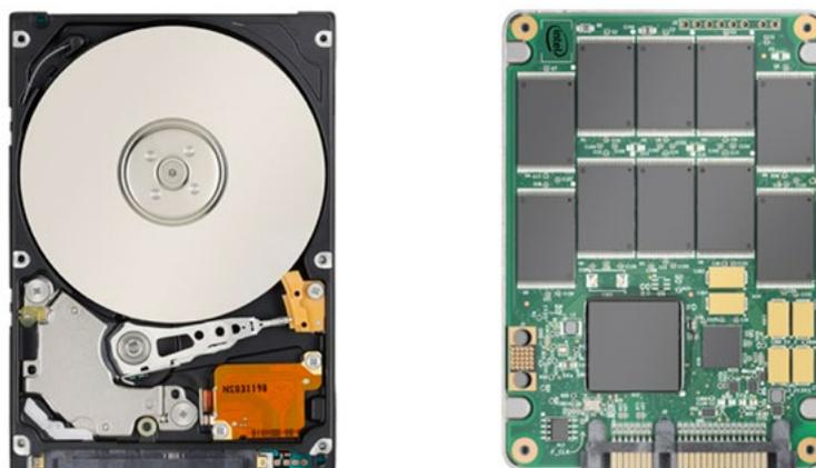
Disco duro magnético versus disco duro de estado sólido. [4]
