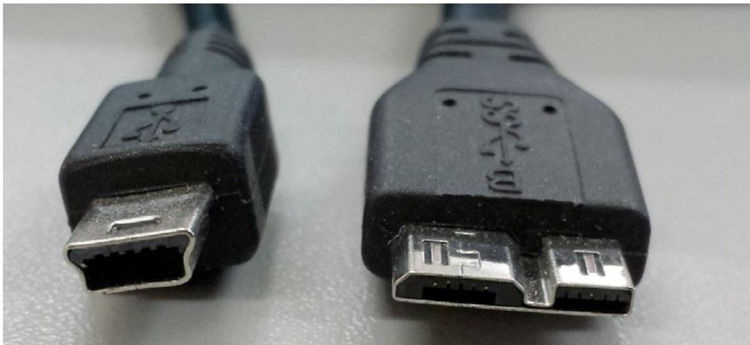
Conectores de disco duro USB. A la izquierda un conector USB Mini-B macho (USB 2.0), y a la derecha un conector USB Micro-B macho (USB 3.0).
