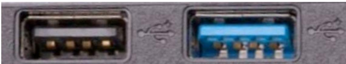
Detalle de dos puertos de conexión USB. El de la izquierda es USB 2.0 y el de la derecha USB 3.0 (tiene el conector pintado en azul).
