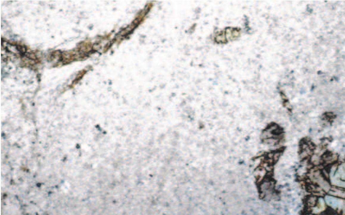
Microfotografía correspondiente a la lamina delgada de la muestra 0802. Caliza. Polarizadores cruzados.
