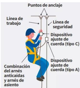
El trabajador por medio de su arnés se conecta a dos líneas: **línea de trabajo** y **línea de seguridad**, separadas y ancladas a una estructura o a dispositivos de anclaje.
