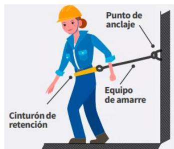
La longitud de la cuerda y la disposición del anclaje impiden alcanzar la zona con riesgo de caída.
