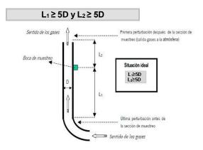
**SE DEBERÁ comprobar** –en todo caso- **y en todo ejercicio de medición** en los diferentes puntos de muestreo, que la corriente de gas en el plano de medición cumple los siguientes requisitos:
