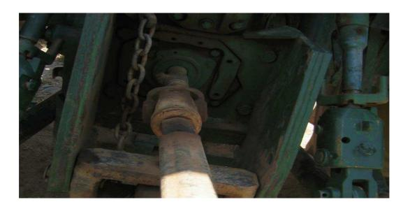
El eje de la toma de fuerza del tractor se conecta al eje de entrada de fuerza de la máquina a accionar mediante un árbol universal telescópico con doble junta cardan. Para ello, ha de tenerse en cuenta que el enganche se efectúe lo más centrado posible.
