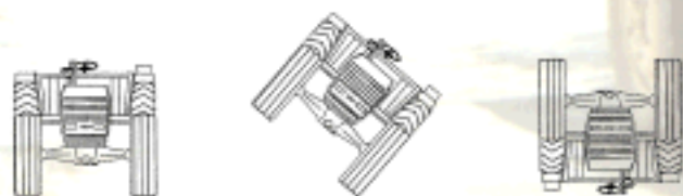
SIN CABINA, RIESGO DE ATRAPAMIENTO
