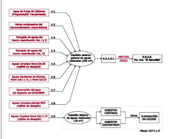
Las aguas de limpieza de las instalaciones de la nave CAT-I y II (efluente numero 9), no son objeto de vertido, ya que son almacenadas y posteriormente trasegadas y evaporadas en los digestores de la planta CAT-I y II, y eliminadas en los oxidores. Las aguas tratadas en la nueva EDARI son objeto del único vertido existente en la industria que es trasvasado hacia la E.B.A.R. (Estación de Bombeo de Aguas Residuales) ubicada en el Polígono Industrial "El Semolilla" de Abanilla.
