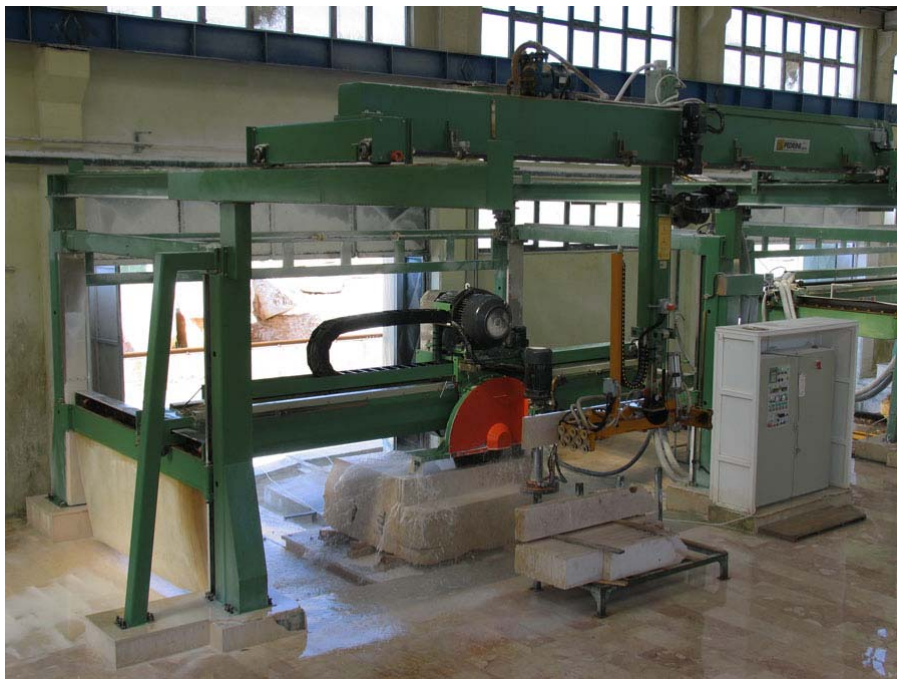
Foto : Cortabloques 4 columnas dotado de descargador automático.
