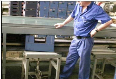
Mesa de rodillos dotada de mecanismo de inclinación para que la caja, una vez llena, se deposite por su propio peso en la cinta
