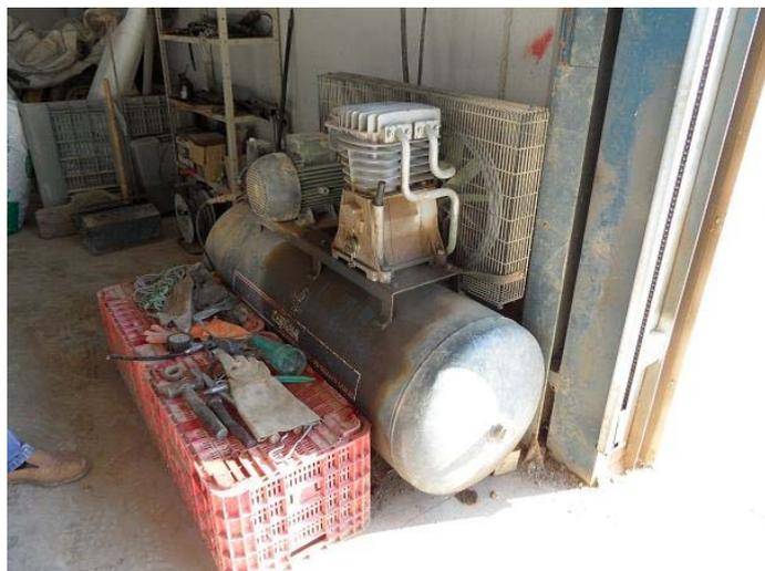
Todos los equipos requieren de mantenimiento. Los usuarios de estas instalaciones deben realizar el mantenimiento de los equipos a presión, accesorios de seguridad y dispositivos de control de acuerdo con las condiciones de operación y las instrucciones del fabricante, debiendo examinarlos **al menos una vez al año**.
