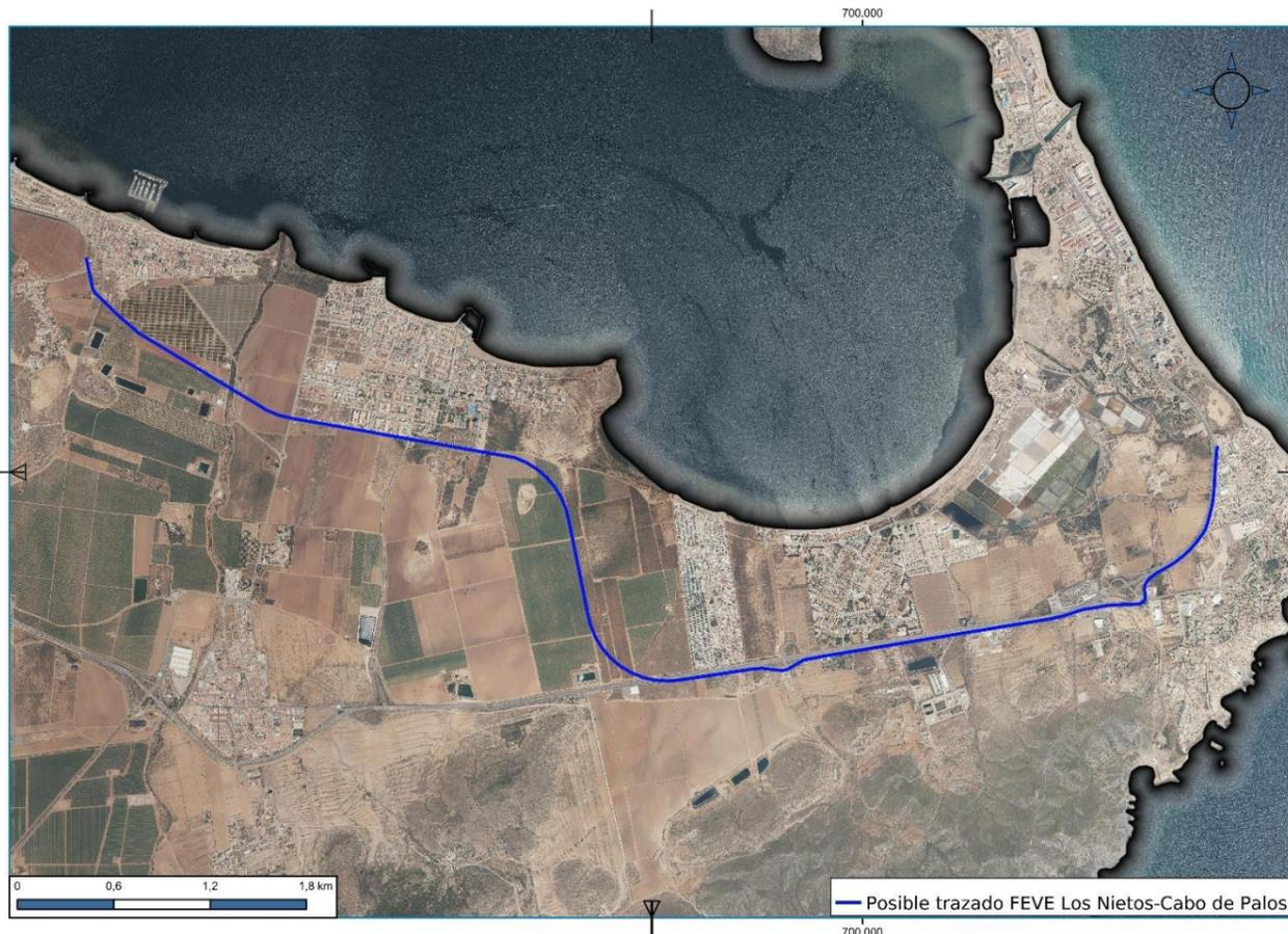
Figura 24. Posible trazado (estimado) de la extensión del FEVE entre Los Nietos y Cabo de Palos. Fuente: Elaboración propia a partir de los condicionantes de ADIF para los proyectos FEVE
