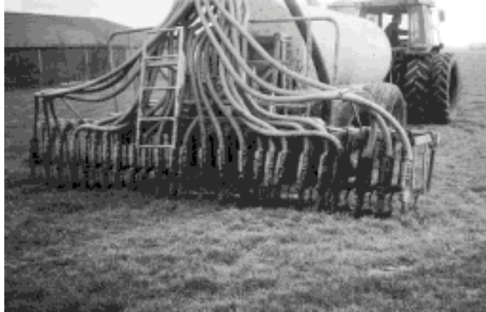
Cuba de 20 Tm para transporte de purines que lleva acoplado un sistema de inyección de purines al suelo agrícola
