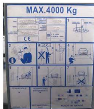
Ejemplo de marcado informativo de un elevador
