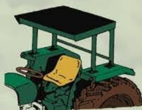
Pórtico de seguridad
