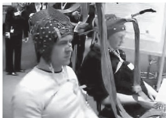
Figura 6. Dos personas interactúan con el ordenador a través de la sustitución sensorial. El programa de ordenador recibe las señales del casco y a partir de las variaciones de actividad de las neuronas el ordenador mueve el cursor en la pantalla hacia la dirección deseada igual que lo habría movido usando las manos.
