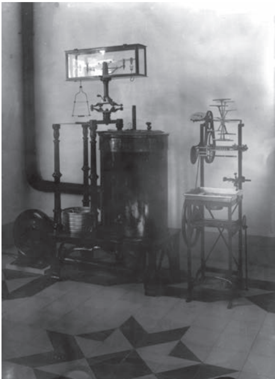
Máquina de desecar seda a peso constante. Hilatura manual de laboratorio
